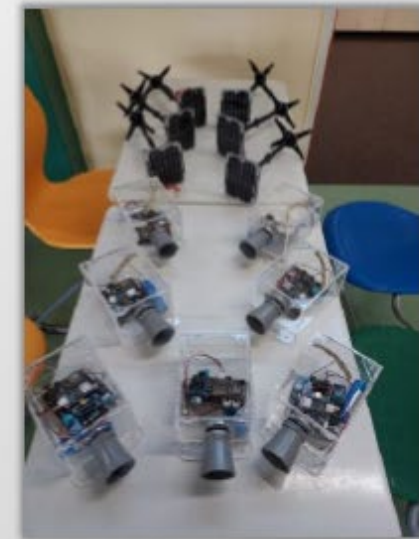
Entwicklung und Bau der Pegelsensoren
