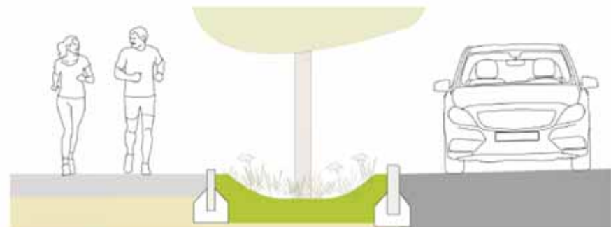
Abb. 38 - Übergang der Mulde zum Gehweg (links) und zur Fahrbahn (rechts)
