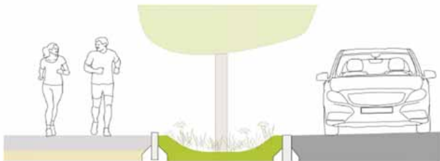
Abb. 40 - Übergang des Tiefbeets zum Gehweg (links) und zur Fahrbahn (rechts)
